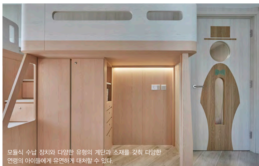
▲ 소재는 아이들의 건강과 지속 가능성의 원칙을 따라 내화성과 E0 등급의 포미카 보드, 난연성이 검증된 합판과 패브릭을 사용했다.
